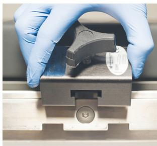
Şekil 2a: Ray kelepçesinin monte edilmesi
