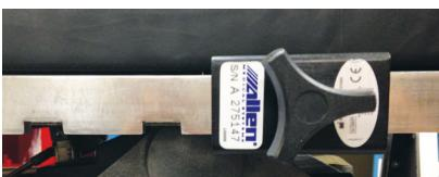
**Figura 2b:** Mueva la abrazadera hacia la derecha desde las ranuras del riel
