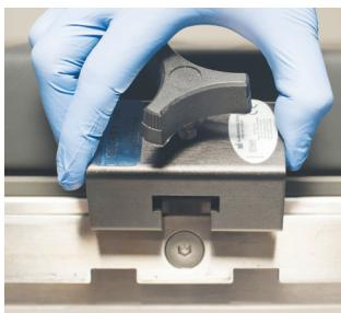
Figuur 2a: Montage van de railklem
