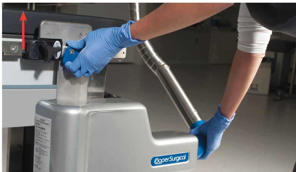
Figuur 4: Verwijdering van de ALLY UPS hoofdunit van de rail
