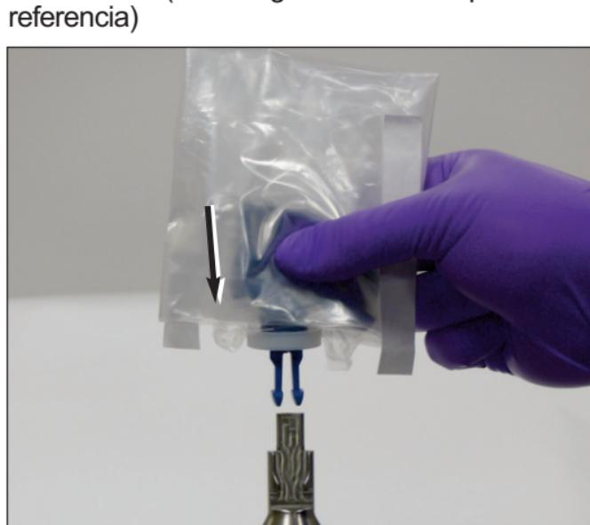
Foto 2a Instalación de la cubierta del adaptador con las pinzas
