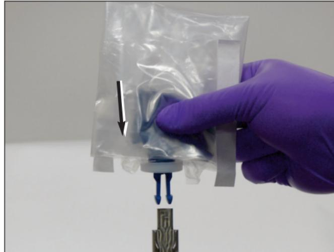
**Photo 2a** Anbringen des Adapter Drape mithilfe der Befestigungsclips
