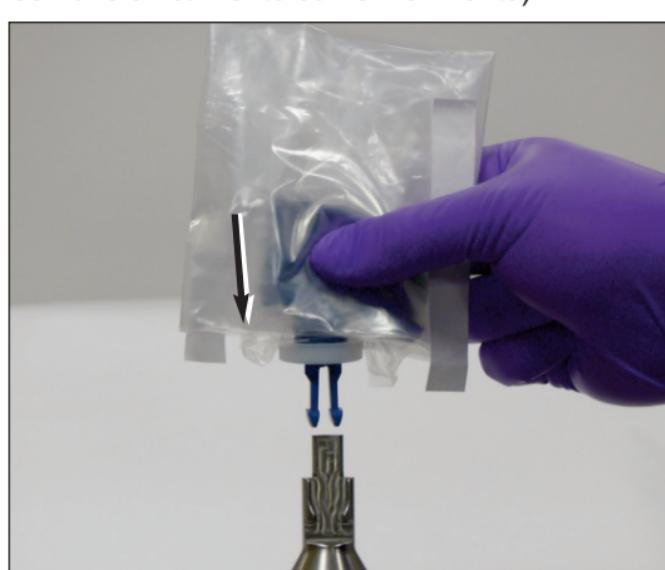
Foto 2a Installazione dell'Telo dell'adattatore con i fermagli
