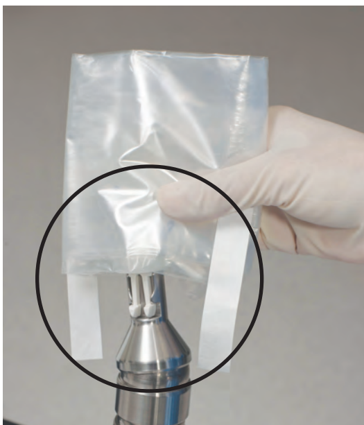
Foto 3b Fermagli in posizione inserita
