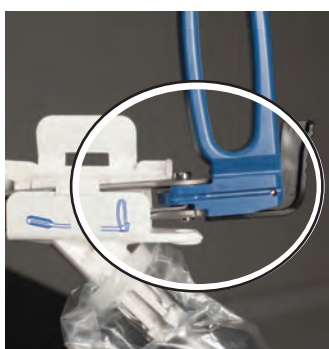
Foto 8 Gelenkpunkt am Griff mit der Aufnahmeöffnung für den RUMI® II Manipulator im Adapter ausgerichtet
