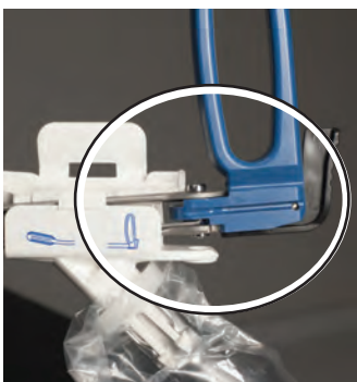
Photo 8 Point de pivot sur la poignée aligné sur l'orifice correspondant du manipulateur RUMI® II dans l'adaptateur
